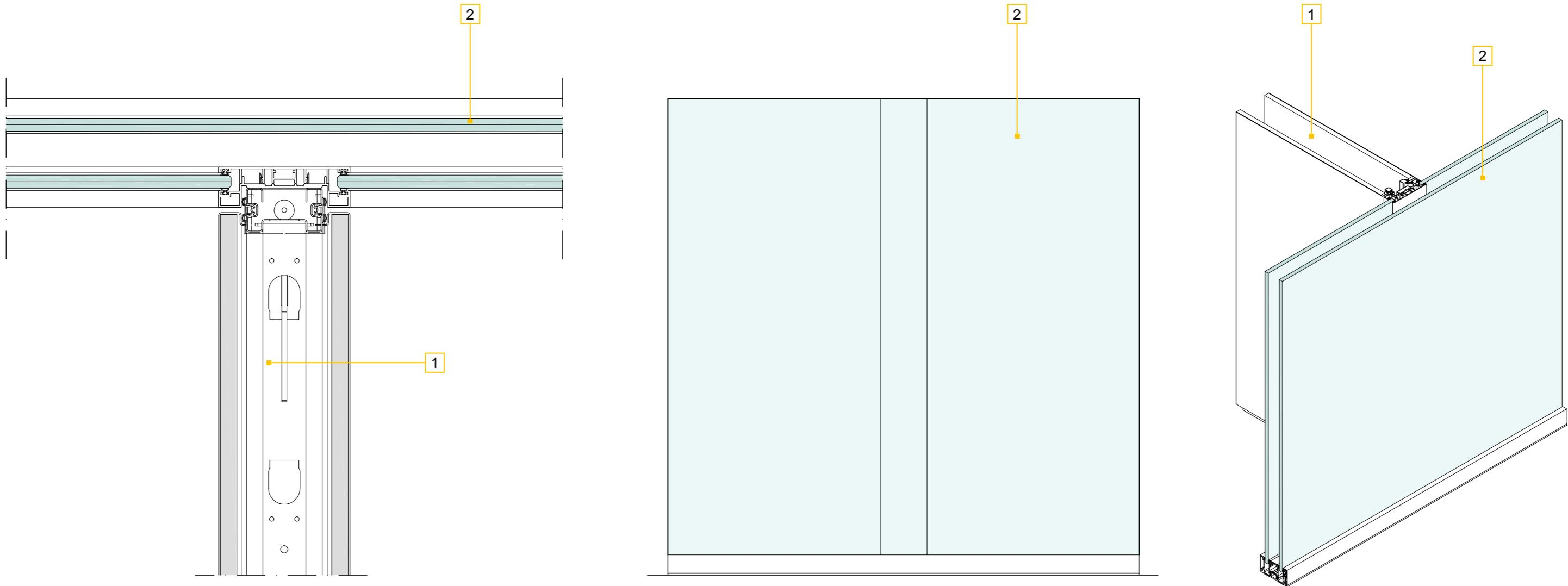
Il sistema Flux ONE permette il passaggio degli impianti in bassa tensione all'interno di particolari alloggiamenti posti al centro della parete (1).
